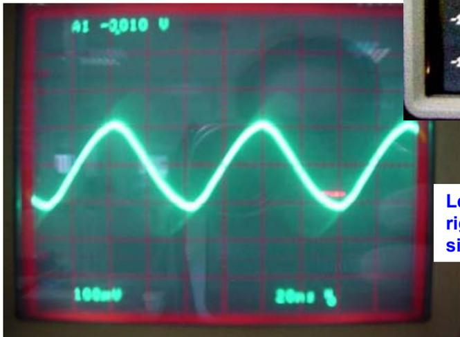
Le signal n'est pas rigoureusement sinusoïdal
