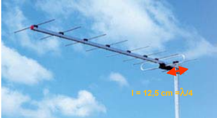
Antenne TV-UHF : 400 à 800 MHz et \lambda \approx 50\text{cm}
