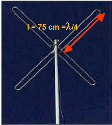
antennes bande FM : 88 à 108 MHz et \lambda \approx 3\text{m}
